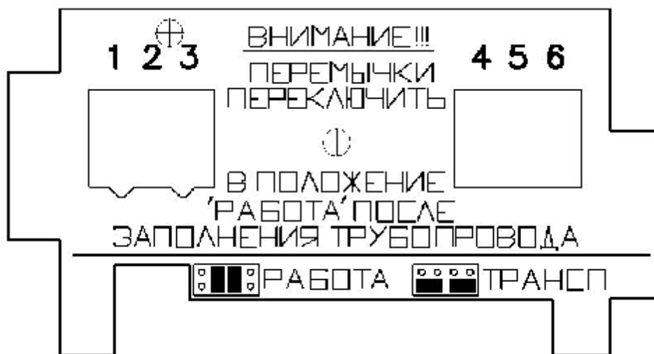
Рис.7 Вид клеммной коробки первичного преобразователя расхода в исполнении Н
