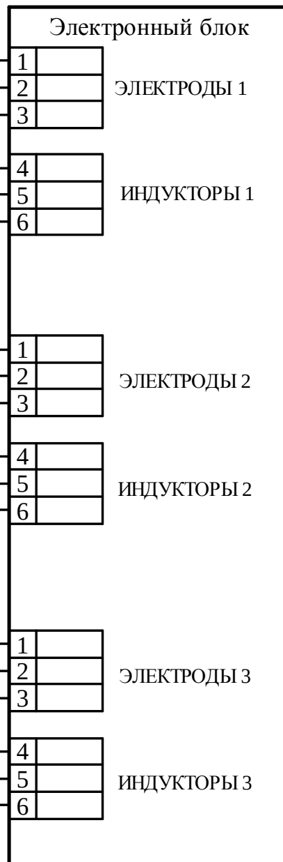
Рис. 2 Подключение преобразователей скорости для систем с дублированием каналов.
